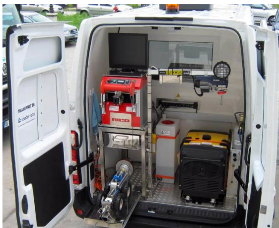
Fig. 5. Laborator de inspecție CCTV
