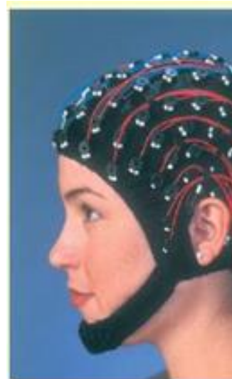
Fig.5. Utilizarea unor senzori portabili pentru măsurarea activității cerebrale
