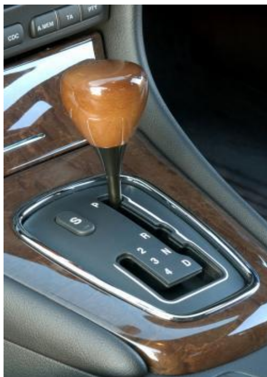
Fig.2. Levier selector de programe la o cutie de viteze automată
