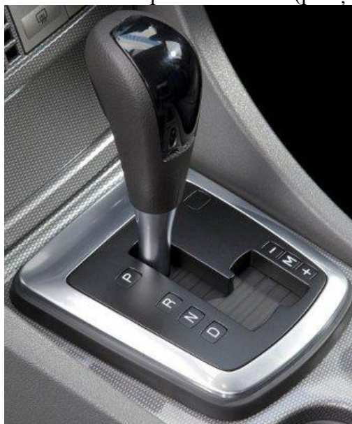
Fig.4. Levierul de acționare a unei cutii de viteze automatizate (Sursa BMW)
