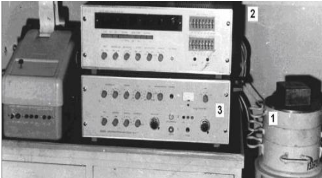
Figura 3 .Vedere a instalației radiometrice.(1)Container de plumb cu numarator scietillation;(2)Contor de impulsuri;(3)Inregistrator de date
