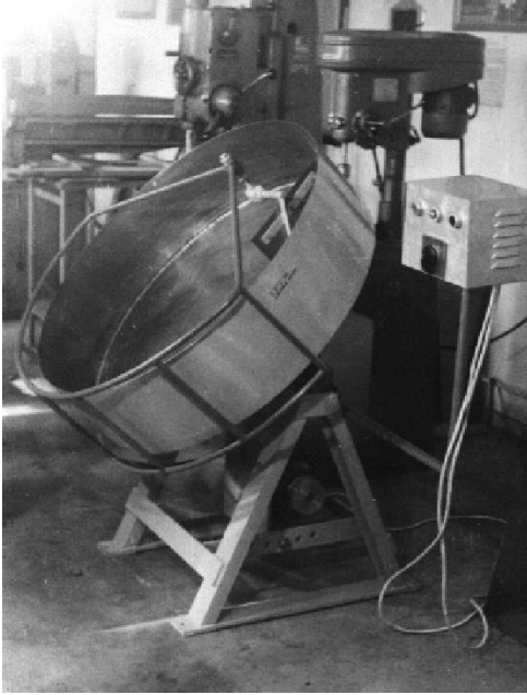
Fig.3. Imagine de ansamblu a instalației pentru granularea pulberii de wolfram și pentru determinarea vitezei de uzare a materialului plăcii deflectoare [1]
