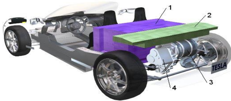
Fig. 4. Tesla Roadster – componente principale (1–bateria, 2–electronica de comandă, 3–motorul electric,4–transmisia.(Sursa: Tesla Motors)
