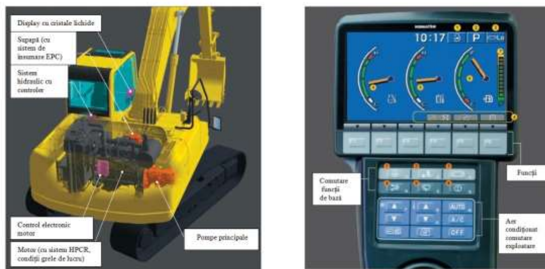
Fig. 2. Structura sistemului electronic pentru comanda, reglarea, monitorizarea funcționării și diagnozei la un excavator pe șenile: a- principalele componente; b-monitorul LCD, care afișează/realizează: 1-autofrânarea; 2-modul de lucru; 3- viteza de deplasare, 4-temperatura apei de răcire a motorului termic; 5-temperatura uleiului hidraulic; 6- consumul de combustibil; 7-sistemul EMMS pentru monitorizarea funcționării și mentenanță; 8-meniul funcțiilor (1- autofrânarea, 2-selectarea modului de lucru, 3-selectarea deplasării, 4-resetarea, 5-comutarea ștergătorului de parbriz, 6- comutarea spălătorului de parbriz).
