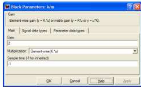
Fig.6. Configurarea blocului amplificator pentru integrarea vitezei
