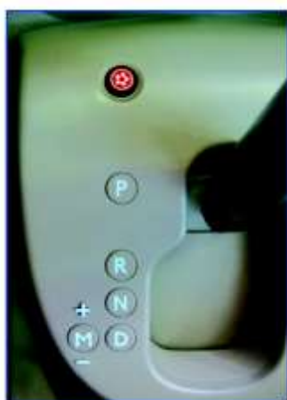
Fig. 1 Schema de acționare a cutiei de viteze robotizate
