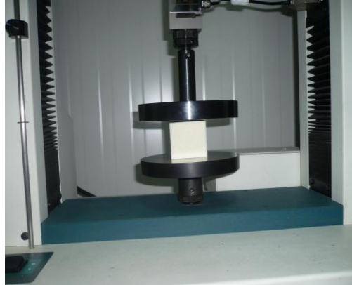
Fig. 2 - Încercarea la compresiune
