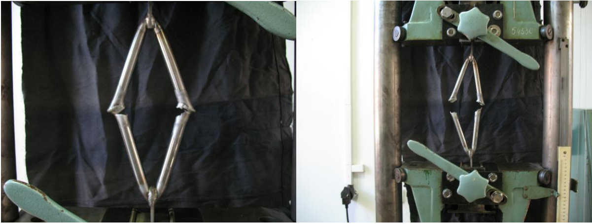
Fig.5 Aparitia si extinderea zonei de rupere a constructiei metalice
