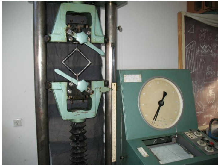
Fig.3 Mod de asezare a structurii metalice in masina de tractiune
