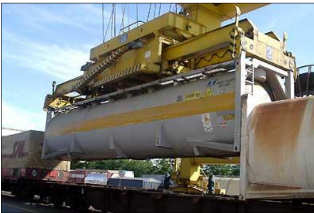
Fig. 1. Transferul unui container cisternă
