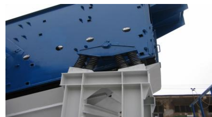
Fig.3. Ciur vibrant 7,5 mp: a – ansamblu general; b – reazemul elastic
