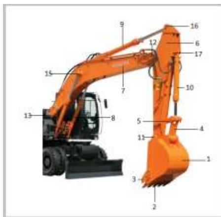
Fig.1. Ansamblul echipamentului de lucru al excavatorului hidraulic: 1- cupă întoarsă; 2 - dinte; 3 - cuțit lateral; 4 - tijă de basculare; 5 - balansier; 6 – mâner; 7- braț monobloc; 8 - cilindru hidraulic de acționare a brațului; 9 - cilindru hidraulic de manevrare a mânerului; 10 – cilindru hidraulic de basculare a cupei; 11 – bolț articulație cupă- mâner; 12- bolț articulație mâner - braț; 13 - bolț articulație braț - platformă rotitoare; 14, 15, 16, 17 – bolțuri cuple cinematice de legătură.
