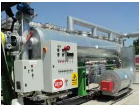
Instalatie mobila de desorbție termica indirecta (DTI)
