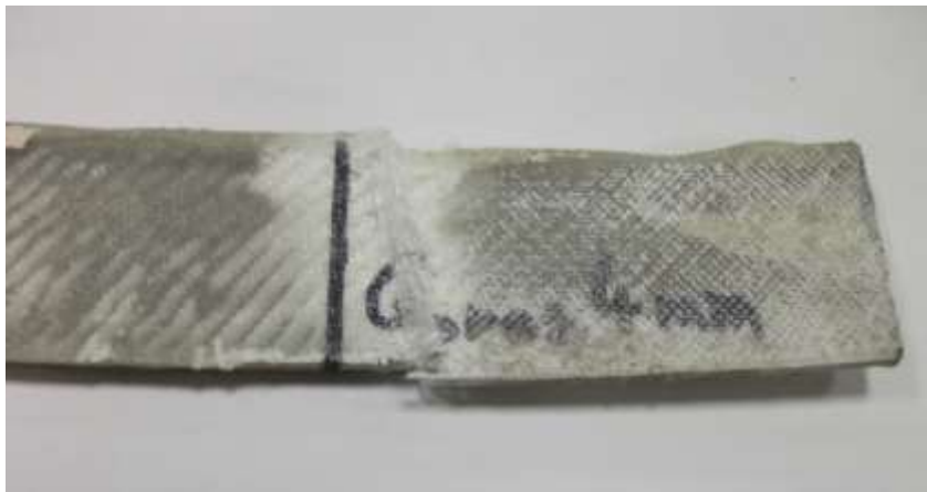
Fig.4 Aparitia si extinderea zonei de rupere a reperului
