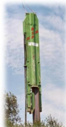
Fig.1.3.2 Echipament terasier de înfigere de tip ciocan vibrator
