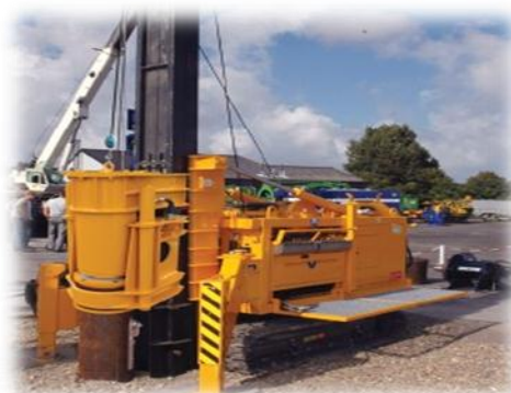
Fig.1.2.1 Utilaj terasier de înfigere prin vibrație
