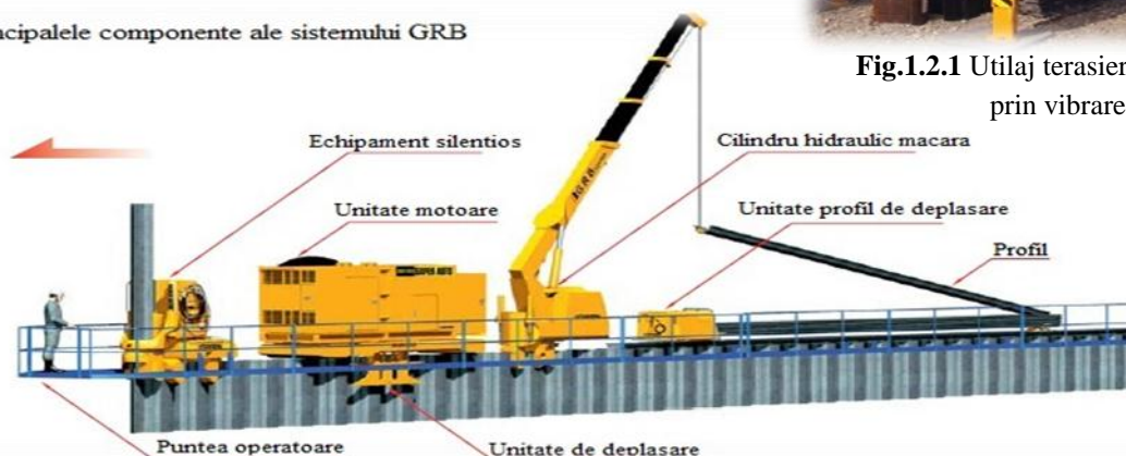
Fig.1.2.2 Utilaj terasier de înfigere silențios
